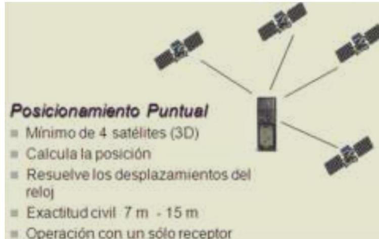
Figura No. 9 - Posicionamiento Puntual o Absoluto
