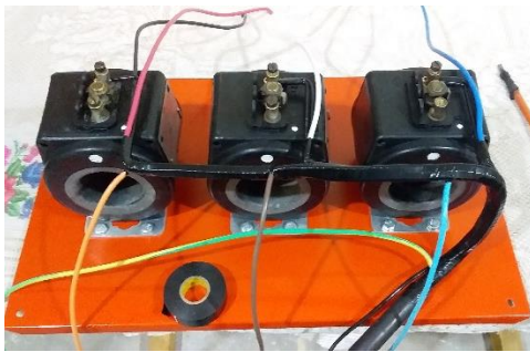
CABLEADO PARA LAS SEÑALES DE CORRIENTE Y TENSIÓN.
