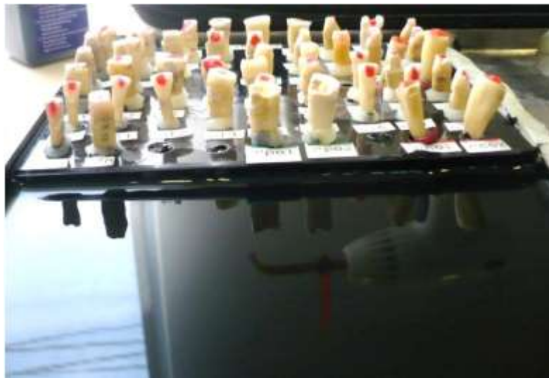
Figura 4 Preparación de muestras de penetración de colorantes (29)
