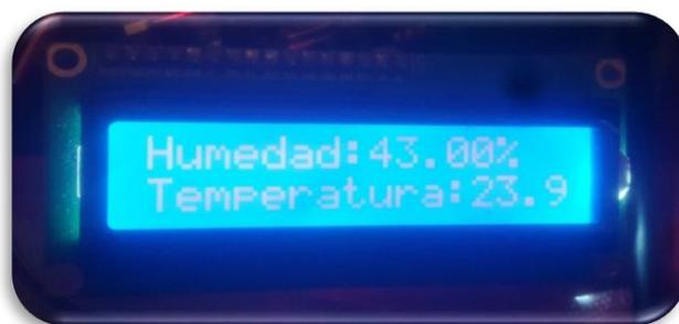
*Figura 4.2: Muestra del control de la temperatura y humedad mediante Display del sensor*
