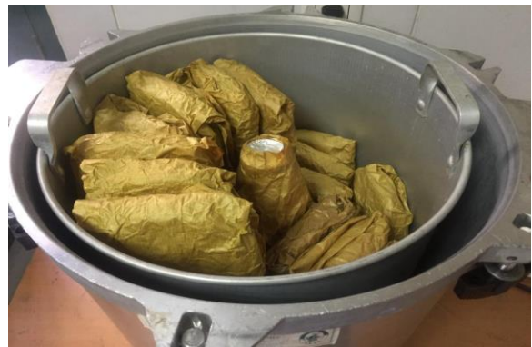
Fotografía 4. Desinfección en olla a presión.
