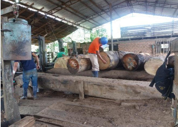
Medición del diámetro de la troza
