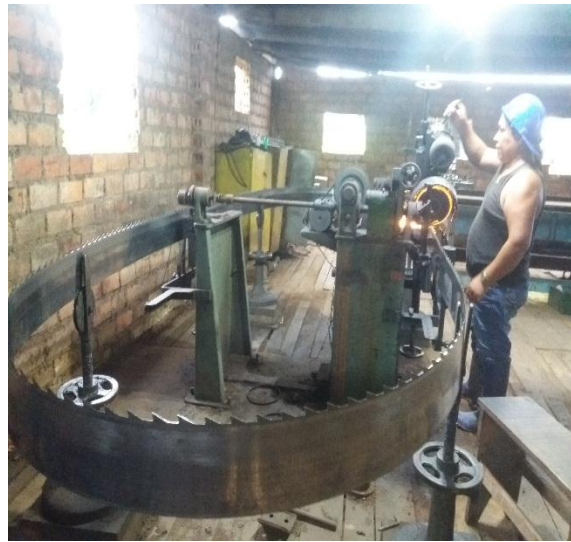
Proceso de afilado de la cinta
