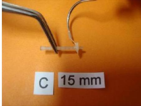
Figura 17. Estado de la resina a 15mm del poste C.
