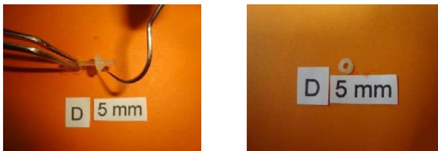
Figura 18. Estado de la resina a 5mm del poste D.
