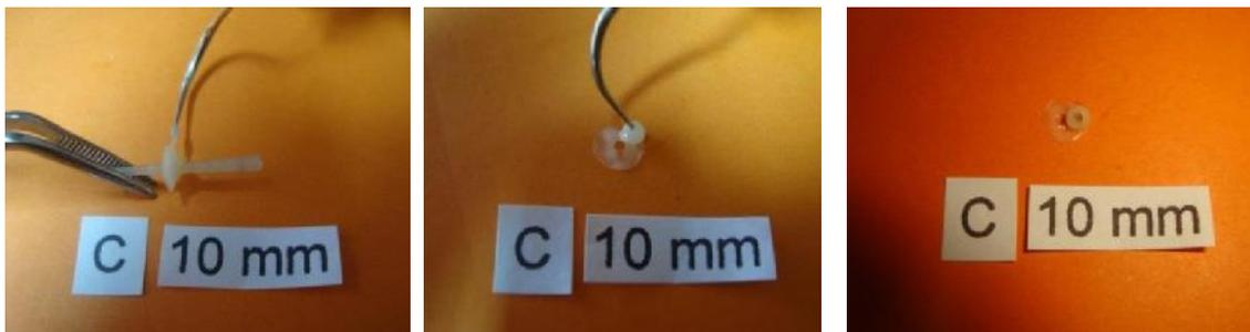
Figura 16. Estado de la resina a 10mm del poste C.
