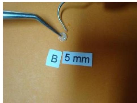
Figura 12. Estado de la resina a 5mm del poste B
