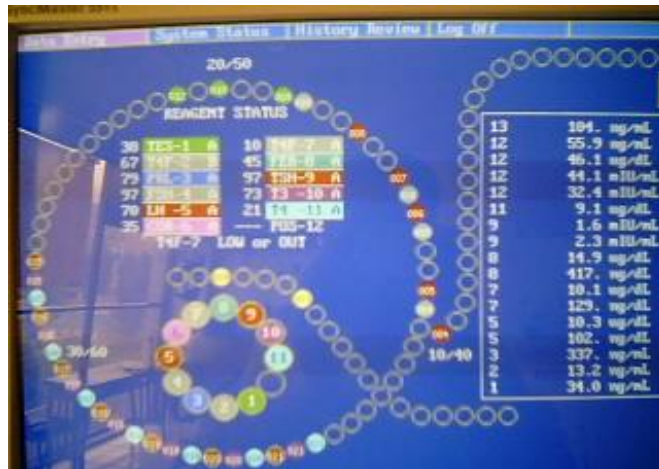
ANEXO 6. Monitor de control para el procesamiento por código de barra y emisión de resultados en la tabla, círculo grande muestras y círculo pequeño reactivos.
