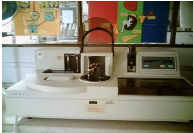
ANEXO1. Equipo INMULITE 1000 para quimioluminiscencia en el laboratorio de Endocrinología y biomarcadores de SELADIS.
