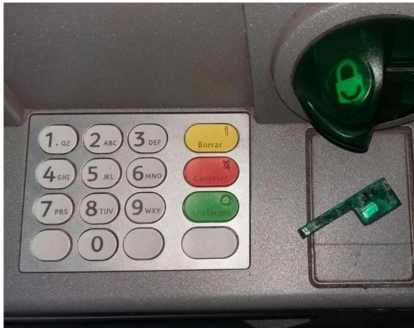
Figura 2 Aparato mediante el cual almacena datos de la tarjeta de débito.
