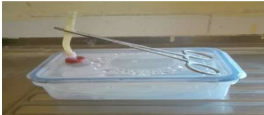
Foto 2. Dispositivo portátil de 500 ml (no convencional) para maduración.
