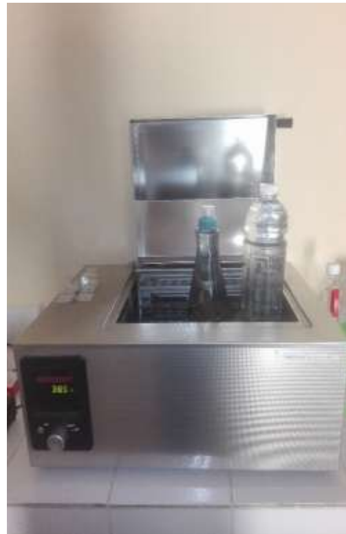
Foto 28. Traspaso del dispositivo portátil con las cajas Petri al baño maría a temperatura de 38.5 °C durante 24 horas.
