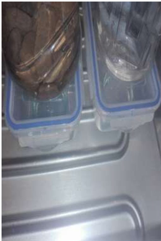
Foto 28. Traspaso del dispositivo portátil con las cajas Petri al baño maría a temperatura de 38.5 °C durante 24 horas.
