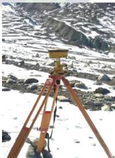
Figura 82: GPS diferencial base estacionado sobre el punto BM1.
