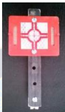
Figura 75: Fotografía de la Placa RS50 pre-instalada sobre una vara de metal con un recodo en el extremo inferior.
