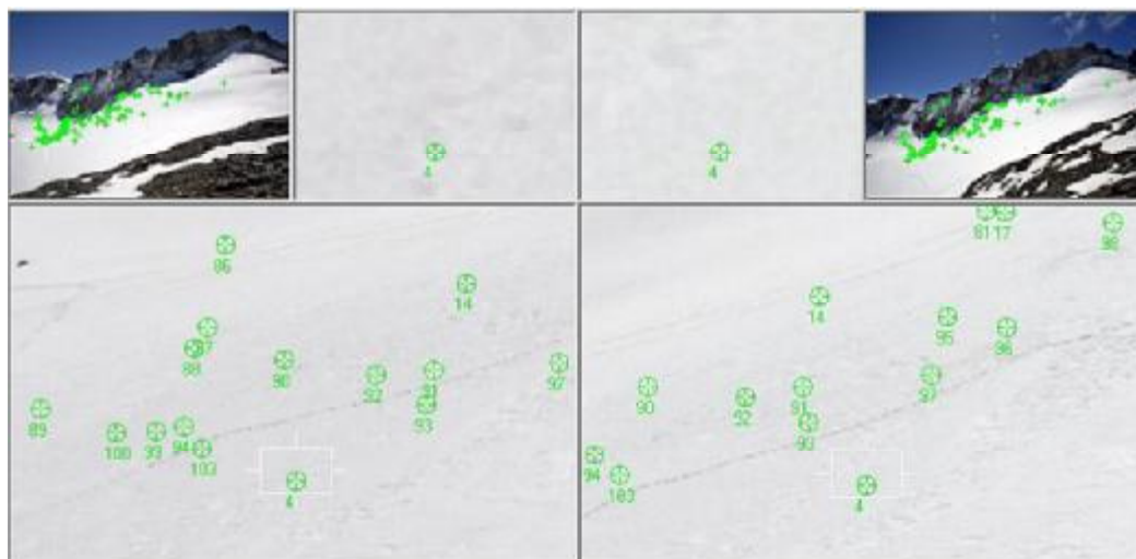
Figura 96: Imagen de la herramienta Point Measurement donde se ve ambas fotografías del primer par estereoscópico fotografía 267 y 282, donde se marcaron los tie points (de color verde) para enlazar ambas fotografías.
