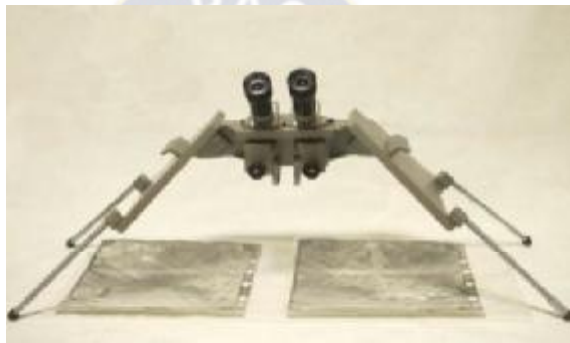
Figura 46: Fotografía de un estereoscopio de espejos utilizado para fotointerpretación de fotografías aéreas.
