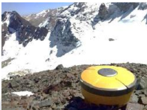
Figura 87: Fotografía de la antena del GPS diferencial (estación móvil) sobre el punto BF3.
