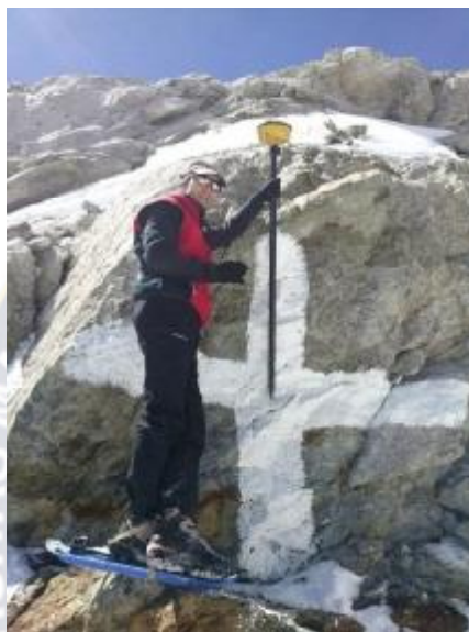
Figura 84: Fotografía de la marca MX1 y el GPS móvil tomando las coordenadas XYZ de posición.
