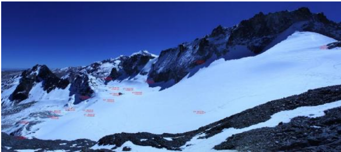
Figura 88: Fotomosaico de las fotografías terrestre 271 – 272 tomadas desde la posición BF2 del glaciar Charquini Sur con los puntos de control y coordenadas.
