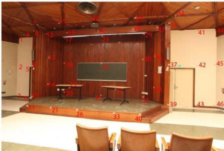
Figura 77: Fotografía del salón Ecrins del laboratorio IRSTEA en Francia, con las marcas topográficas instaladas (Soruco)
