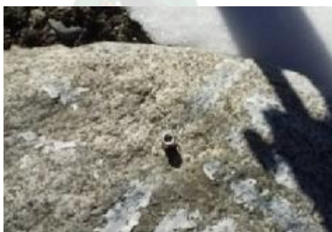
Figura 83: Punto base BM1 donde fue instalado el GPS diferencial estación base.
