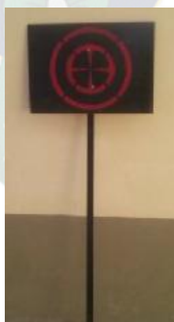
Figura 78: Fotografía de la marca tipo MT tomada antes de su instalación en el glaciar.
