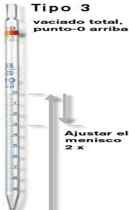
Ilustración 6: Pipeta graduada tipo 3
