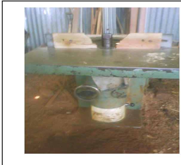
Foto 3.6 Máquina Tupi Potencia 5.5 KW.
