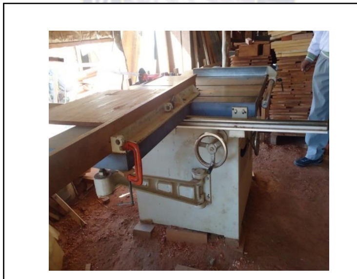
Foto 3.3 Máquina Múltiple Potencia 5.5 KW
