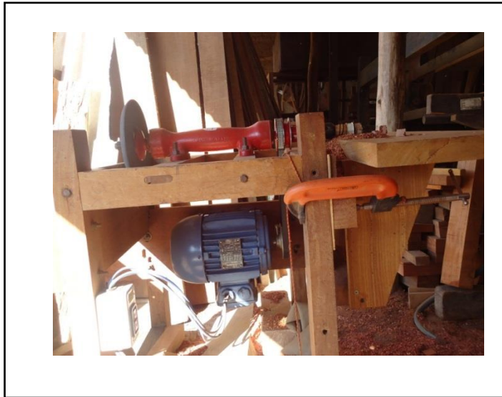
Foto 3.8 Máquina Torno Potencia 4.0 KW
