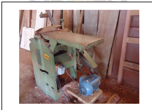
Foto 3.7 Máquina Lijadora Potencia 4.0 KW
