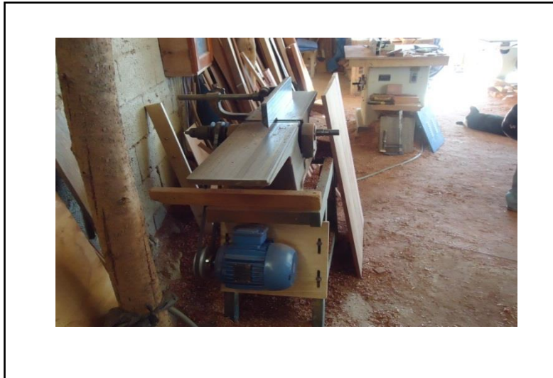
Foto 3.4 Máquina Cepilladora Potencia 5.5 KW
