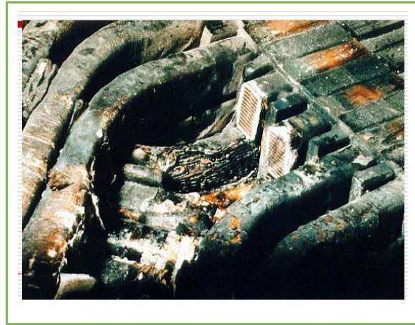
Figura 2.9 falla fase - tierra Fuente: www analisis motor eléctrico.com
