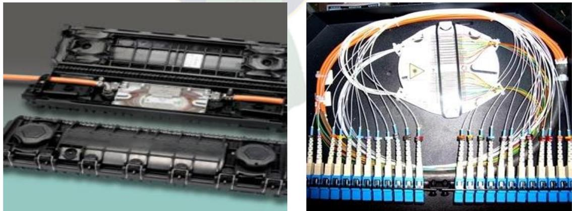
**Figura 2.17 Cajas de empalme y bandejas fusionadas**
