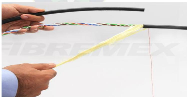
**Figura 2.12 Desenchaquetado de la fibra óptica**
