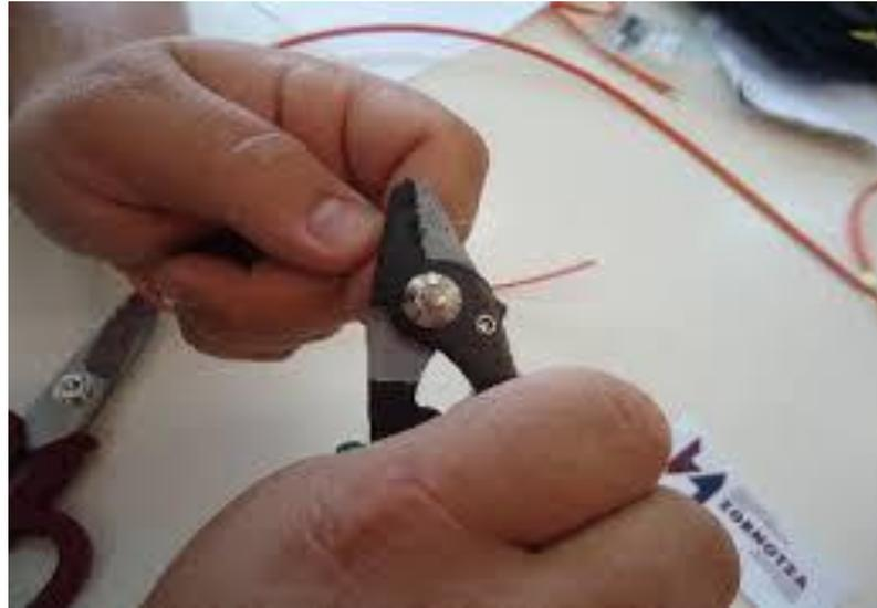
**Figura 2.14 pelado de los hilos de fibra óptica**
