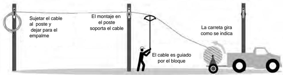
**Figura 2.6 Desplazamiento de bobina**
