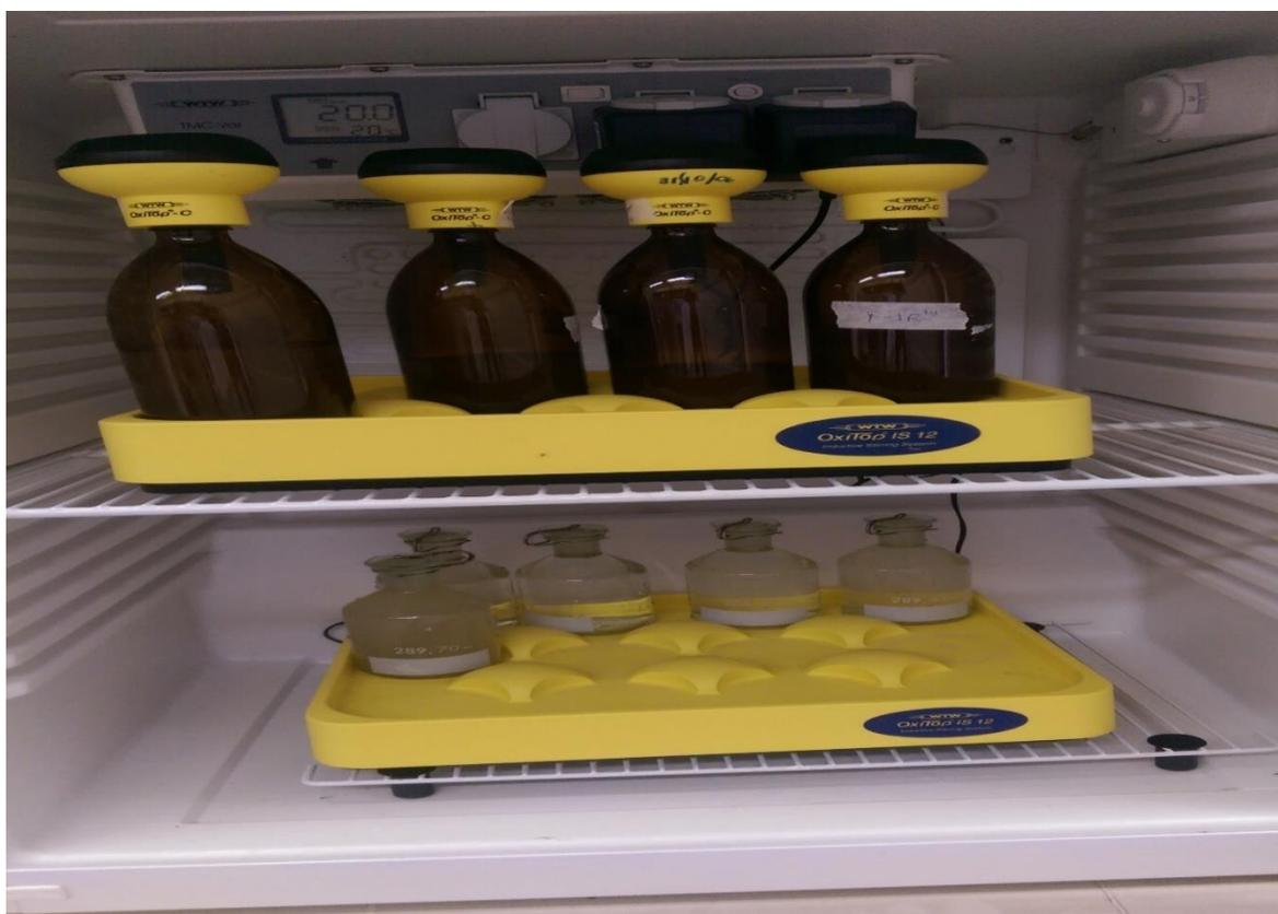
**Incubación método repirometrico – manométrico, Winkler.**
