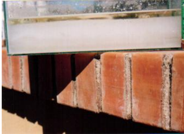
Figura 7.- Precipitación de sales por evaporación solar.
