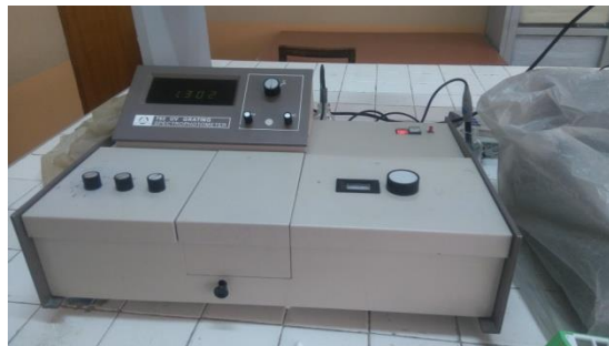
Figura 33. Espectrofotómetro donde se realiza la lectura de absorbancia del antígeno y tubo nº 5 de la escala para el ajuste de densidad.
