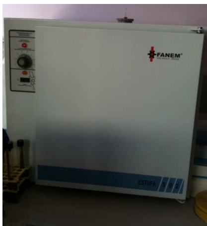
Figura 20. Estufa de cultivo microbiológico donde se incuba el cultivo de S. schenckii . Fuente: Elaboración propia
