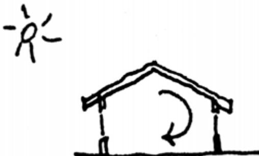
Es el transporte del calor mediante el movimiento de un fluido como el aire, agua, etc.
