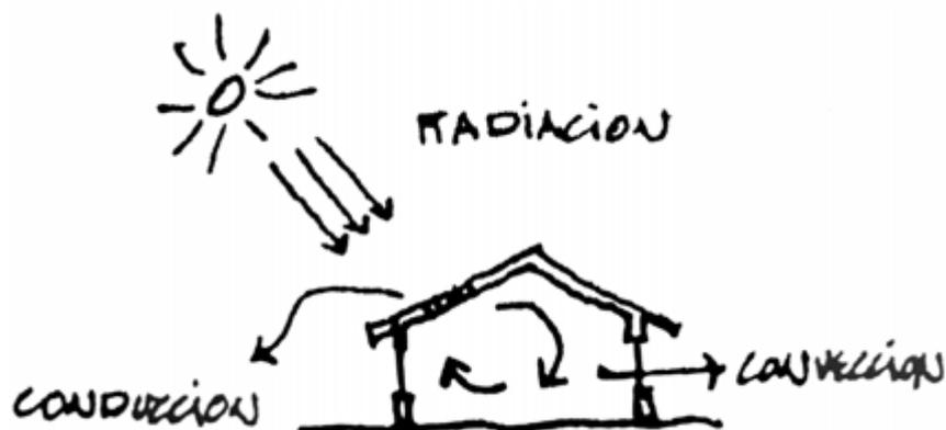
El control de la suma de los tres fenómenos mediante un diseño adecuado, dará por resultado el confort térmico, por el contrario la falta de cuidado en el diseño de estos aspectos motiva incomodidades que pueden afectar las actividades que se llevan a cabo en el interior del una nueva construcción. •
