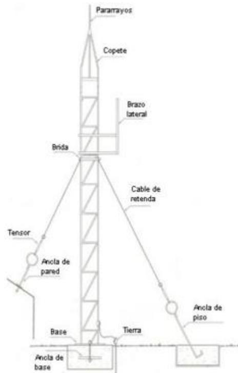
**Figura N°13** Estructura de una torre
