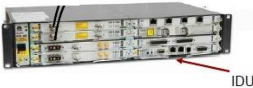
**Figura N°24.** Fotografía de la Unidad Interna (manual de instalación OPTIX RTN 620 Huawei).
