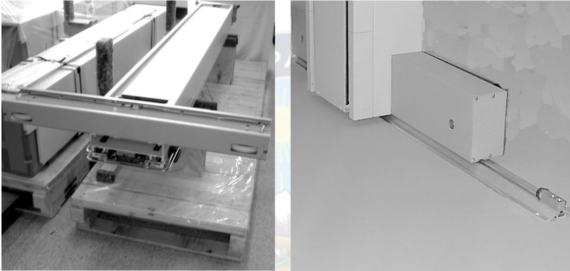
fig. 2.12 Colocado de la columna del Tubo de Rayos X
