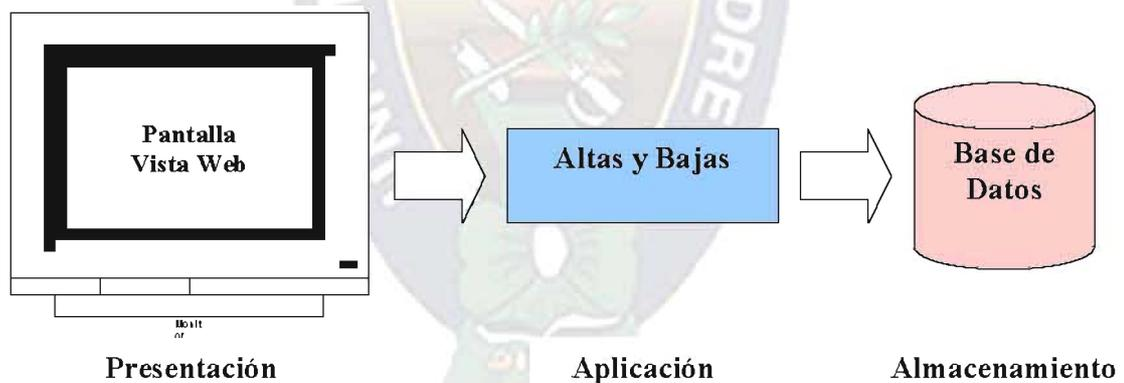
*Figura 2.6 Vista Clásica de una Arquitectura de Tres Capas*
