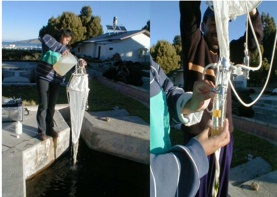
Figura 13. Muestreo de 10 lts de agua con la red de zooplancton y vaciado de muestra a frasco con formol 10%
