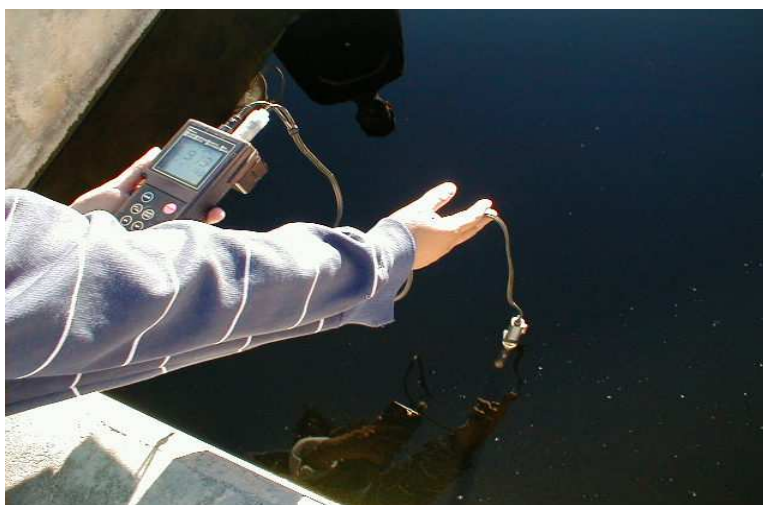
Figura 12. Toma de datos de T° y pH del agua CIDAB – Tiquina
