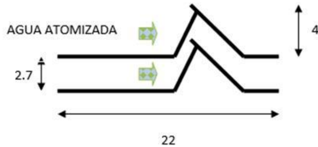
ESQUEMA 7 DIMENSIONES DE LAS ALETAS DEL SEPARADOR DE GOTAS
