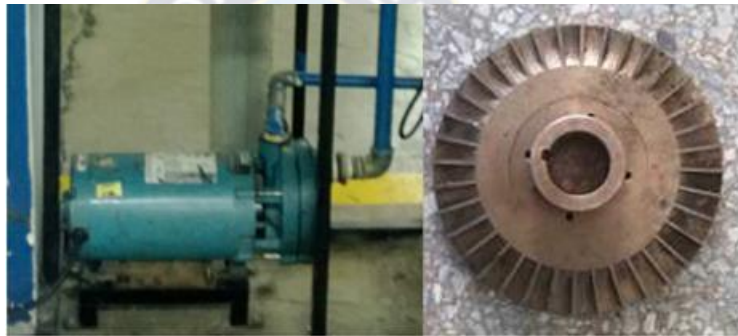
FOTO 16 DAÑO EN EL IMPULSOR O RODETE DE LA MOTOBOMBA
