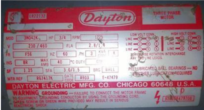
FOTO 6 PLACA DE CARACTERÍSTICAS DEL MOTOR
