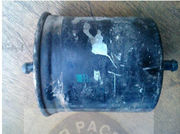
Figura N° 4 Filtro Obstruidas por Suciedad
