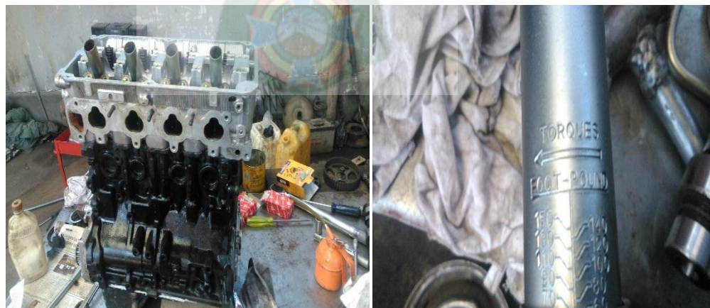
Figura N° 18 Montaje de la Culata y Torqueado de los Pernos
