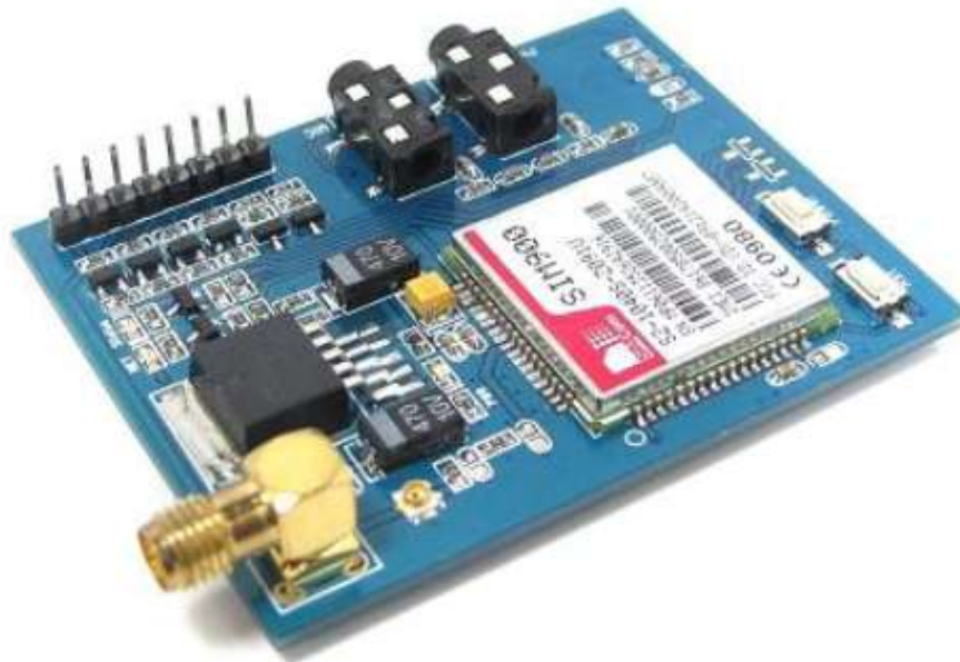
Figura 2.8 Módem SIMCom SIM900
