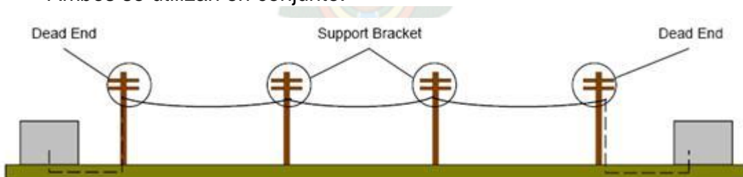
Figura 4.3-8: Herrajes para cables de tendido aéreo
