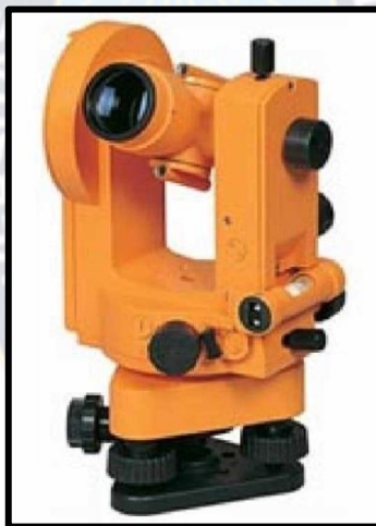
FIG. 4.- TEODOLITO UNIVERSAL T2 FUENTE: WEBDELPROFESOR.ULA.VE
