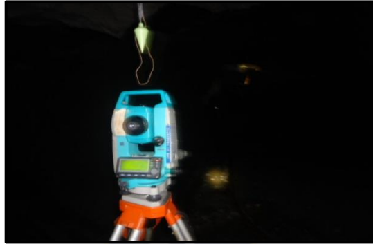
FIG: 39 ESTACION EN TARUGO PARA ALINEAMIENTO FUENTE: PROPIA
