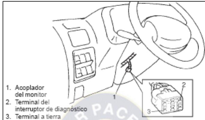
**Figura 19. Acoplador del Monitor**
