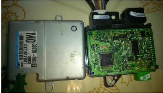
**Figura 25. Módulo de control P/S**
