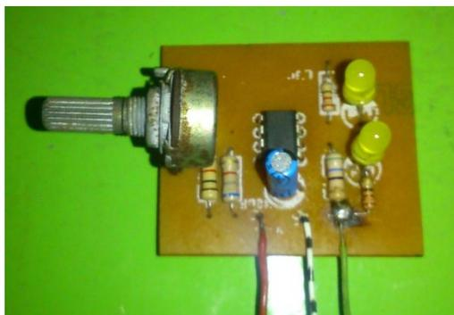
Figura 30. Generador de pulsos.
