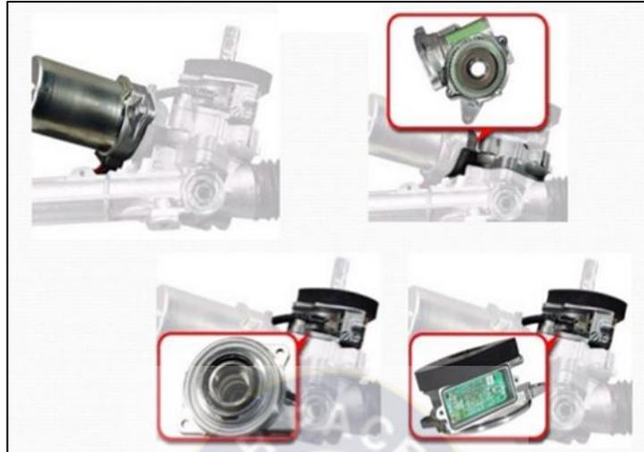
**Figura 8. Partes nuevas del sistema de dirección EPS**
