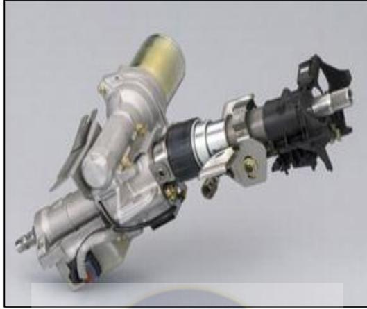
**Figura 6. Sistema de dirección asistido eléctricamente**
