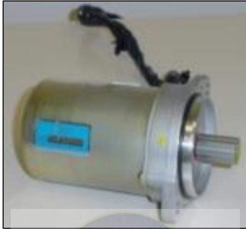
**Figura 9. Motor eléctrico de una EPS**
