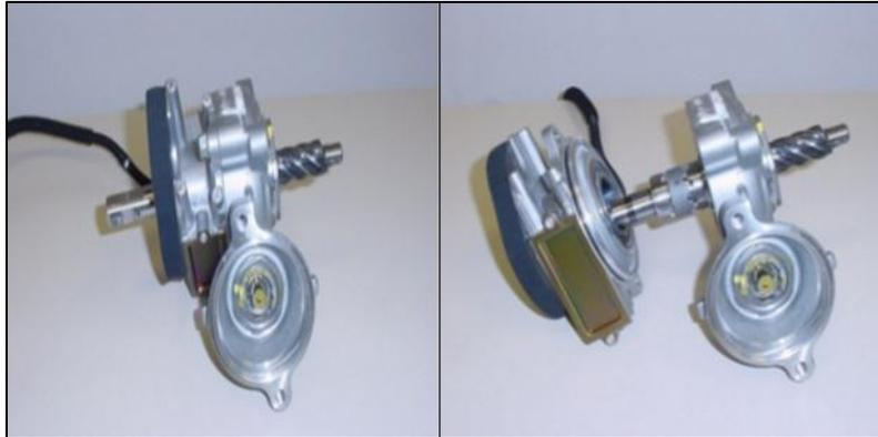
**Figura 11.Reductor –eje volante**
