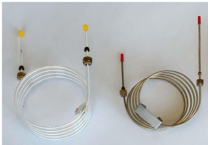
Figura 20. Columnas empaquetadas para cromatografía de gases
