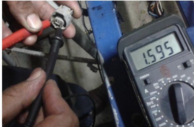
Figura 50 Medición de la resistencia de la rueda delantera, con un multítester digital. R=1.6\text{ K}\Omega
