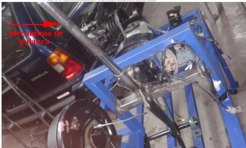
Figura 42 Mecanismo de palanca Para reducir el esfuerzo
