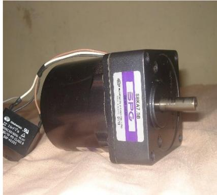
**Figura 4.8 Motor monofásico**
