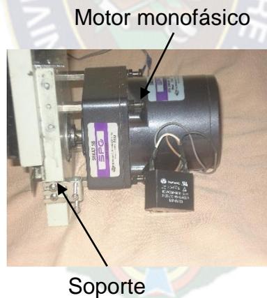
**Figura 5.4 motor monofásico a implementar**
