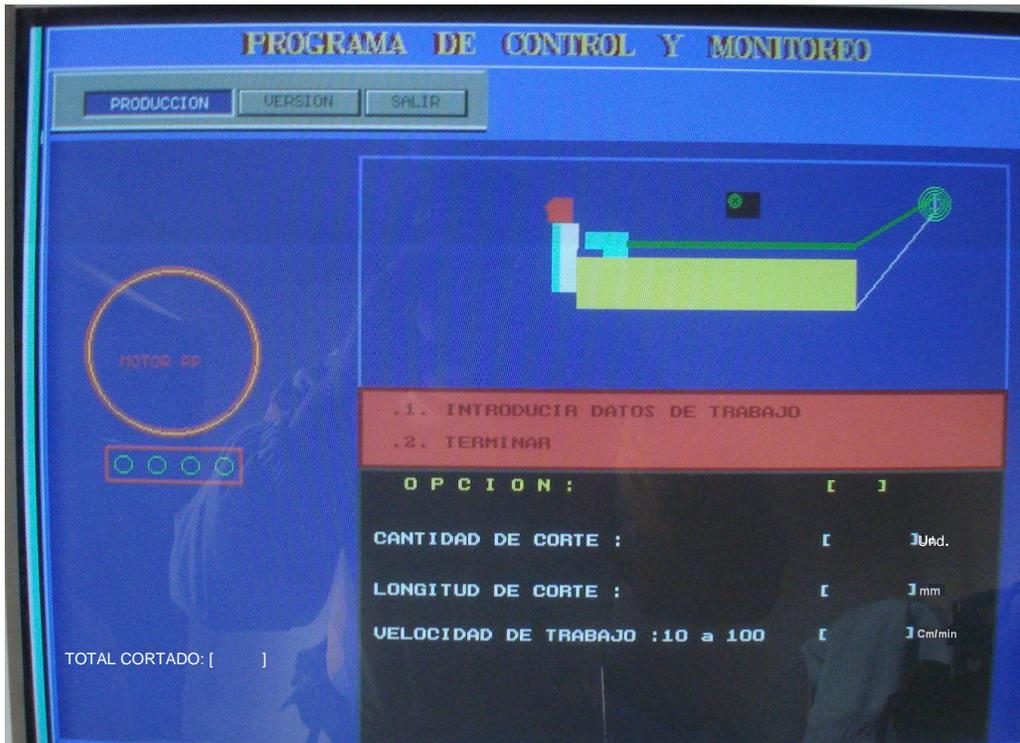
Indicadores de monitoreo motor paso a paso y la maquina implementada con sus señalizadores correspondientes.
