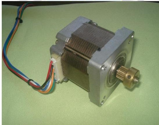
**Figura 5.10 motor paso a paso a implementar**
