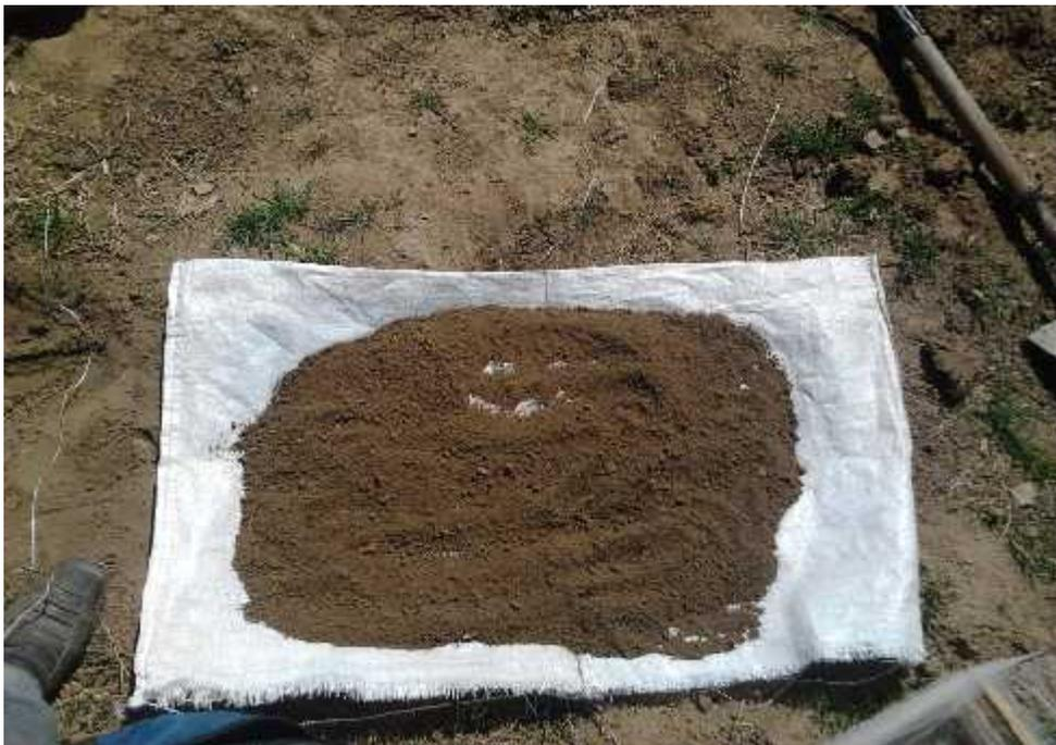
*Figura 22. Toma de muestra para analisis físico químico de suelo (Cuarteo).*
