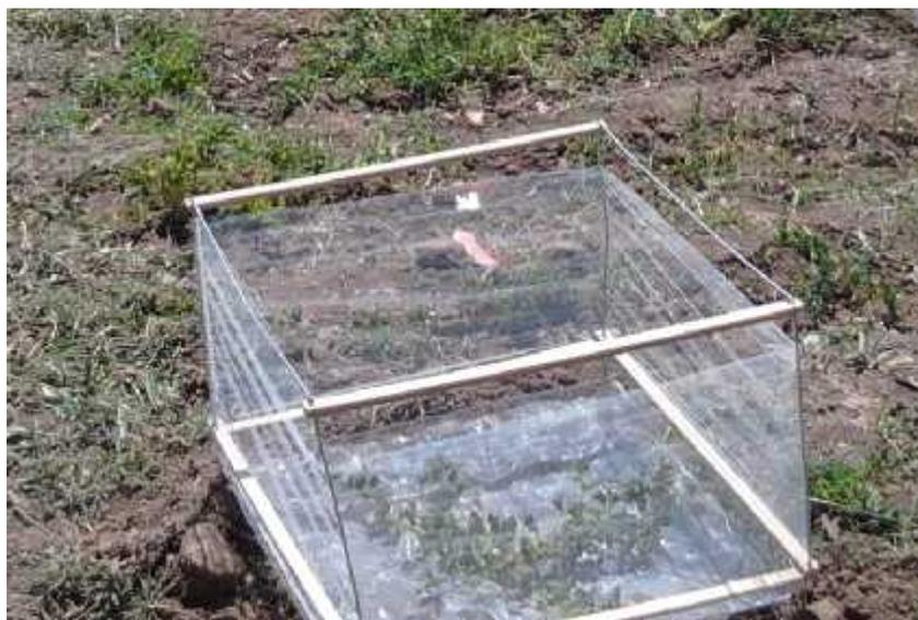
**Figura 2. Colector de grano implementado en terreno para la recolección de grano caído.**
