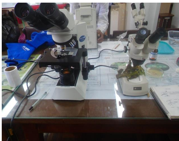
Figura 12. Microscopio y Estereoscopio donde se identificaron los agentes causales de las enfermedades del Durazno
