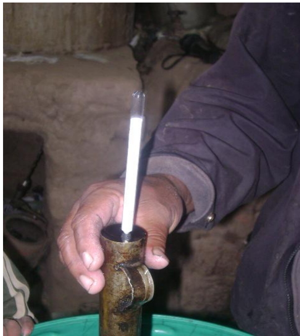
Anexo de figura N° 10 medición del grado alcohólico del licor de chirimoya
