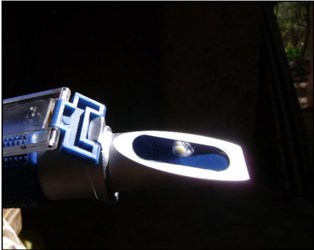
Figura 15. Medición de los Grados Brix, con un Refractómetro
